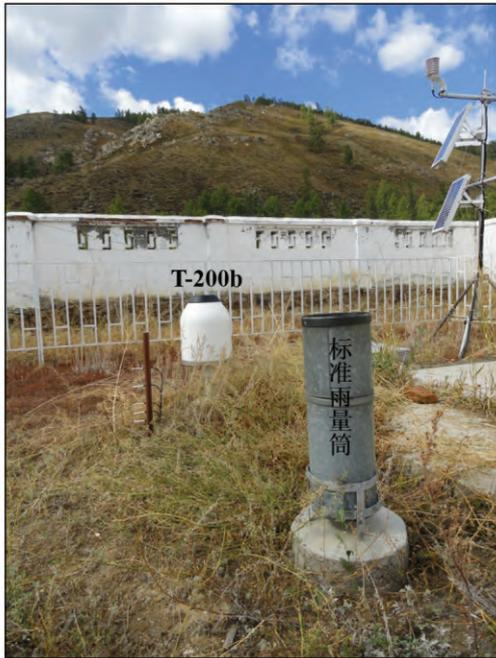
图 1 库威水文站  $\phi 20$  cm 型标准雨量筒和库威积雪站 T-200b 自动降水观测设备
