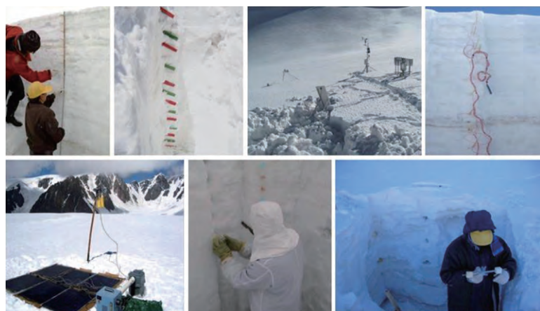
图4 大气—积雪—冰川冰演化物理、化学过程观测与取样工作
