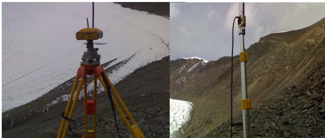
图 5-4 乌鲁木齐河源区 1 号冰川测量 GPS 基准站
