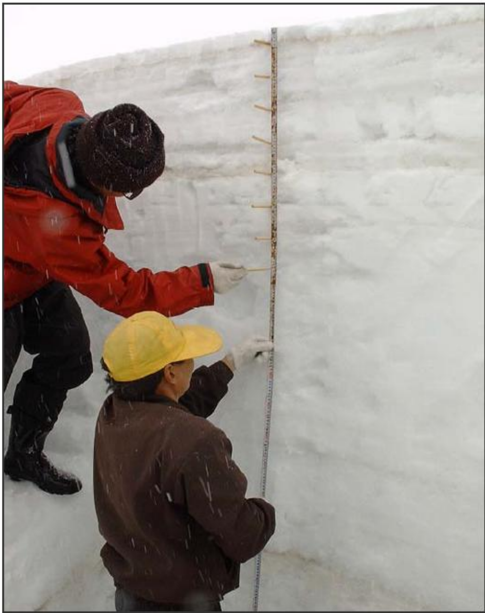
图 3.2 雪层剖面厚度测量
