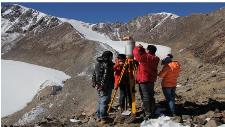
图 3-8 GPS-RTK 技术对基准点进行定位
