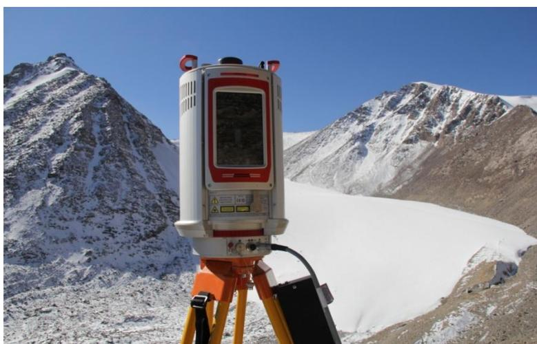
图 3-9 Riegl VZ-6000 地面三维激光扫描仪对 1 号冰川东支实施精细扫描
