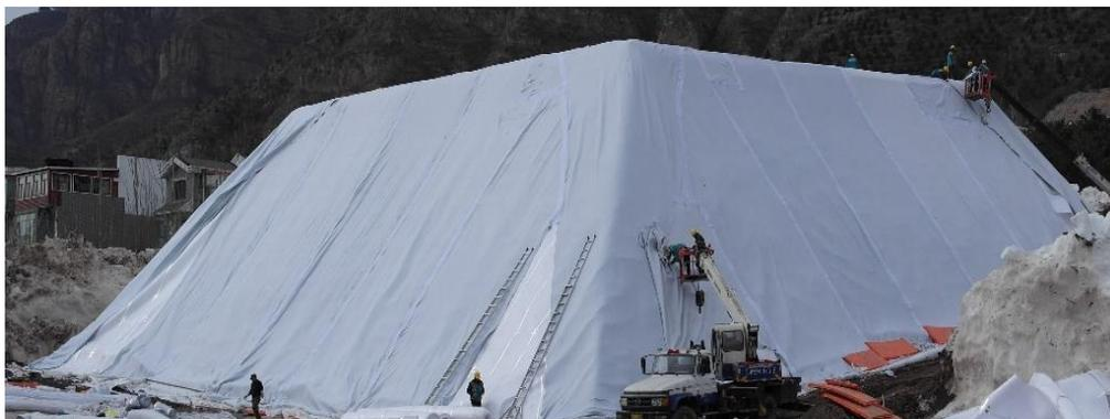
图 6.2 储雪试验人工雪堆
