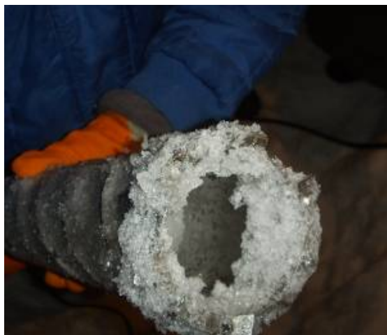
照片 1 冰芯钻头被粘稠状粒雪包裹
