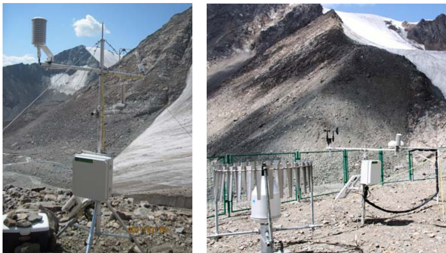
图 3 塔下监测场安装的涡动协方差系统及自动气象站
