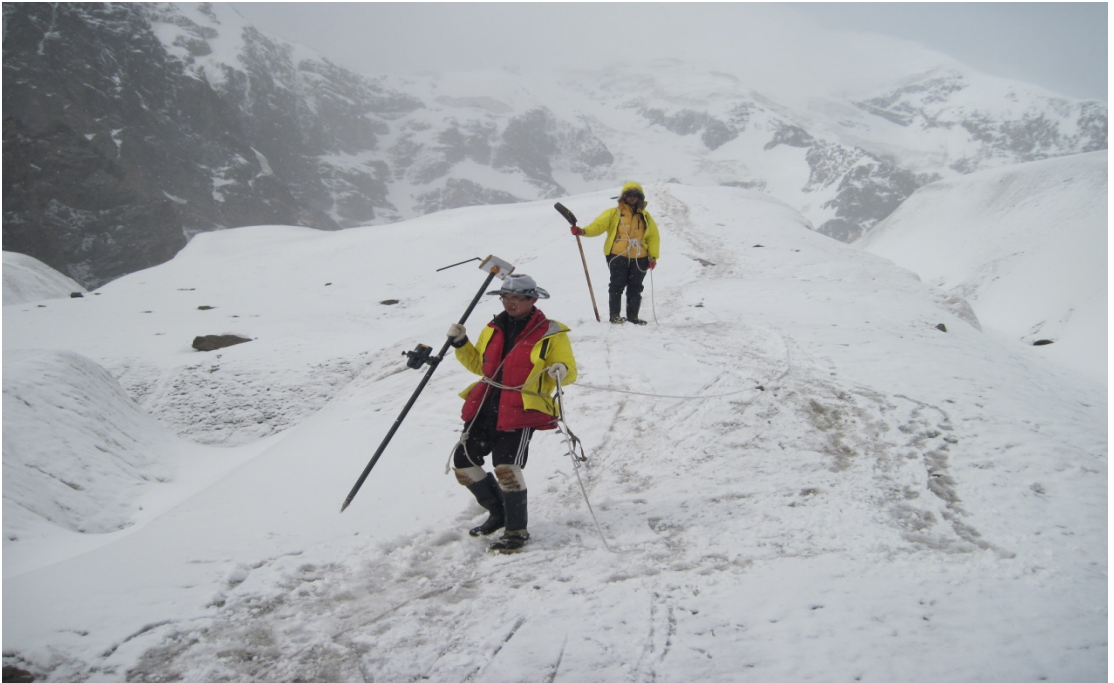
青冰滩 72 号冰川 RTK-GPS 冰面高程变化观测
