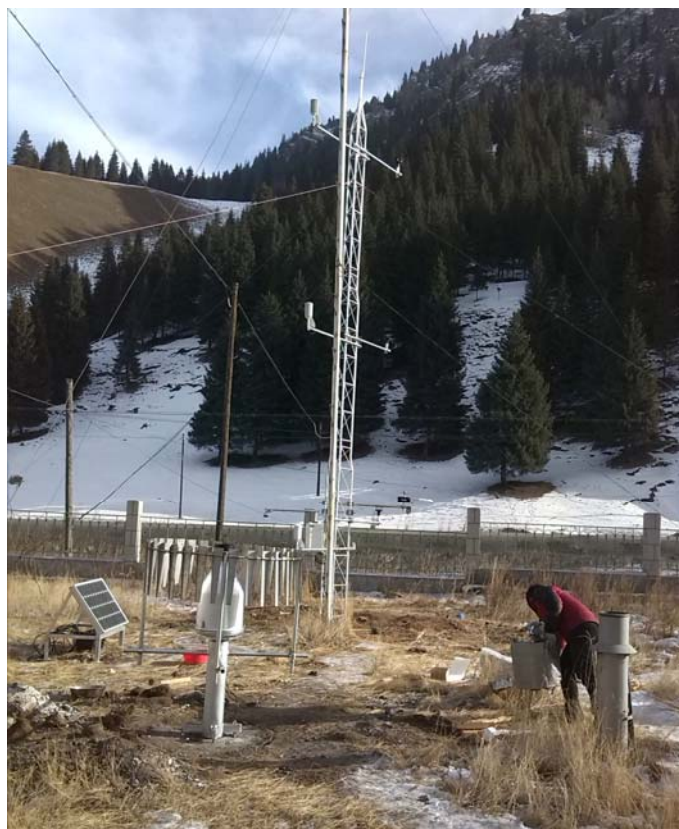
图3-1 天山冰川站基本站气象观测系统升级改造
