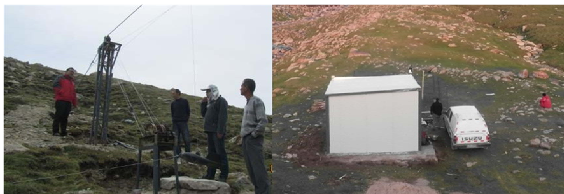
图 3-3 榆树沟冰川末端水文断面缆道测量装置及观测用房
