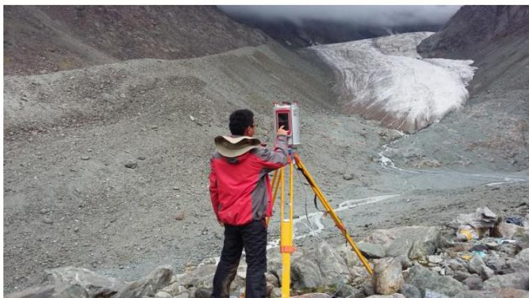
图 榆树沟冰川三维激光扫描作业现场
