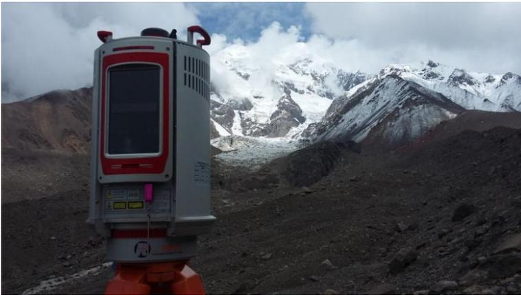
图 青冰滩72号冰川三维激光扫描作业现场
