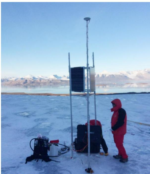
图 GNSS 跟踪站数据采集及维护
