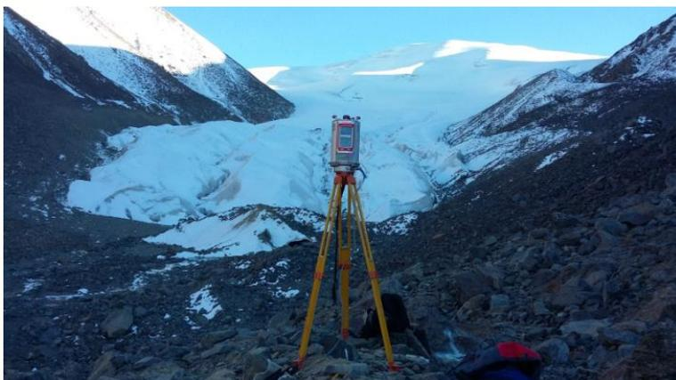
图 祁连山七一冰川地面三维激光扫描
