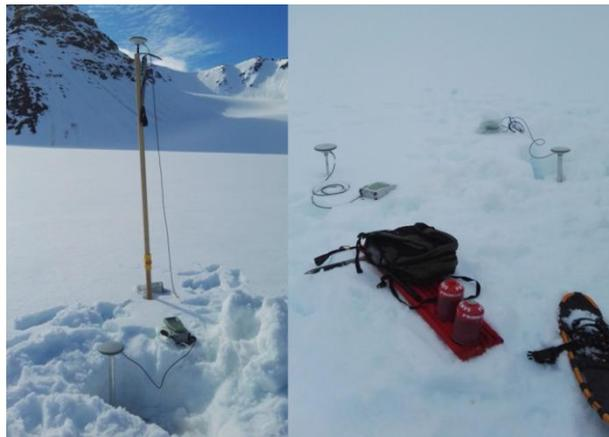
图 冰川运动高精度 GPS 测量
